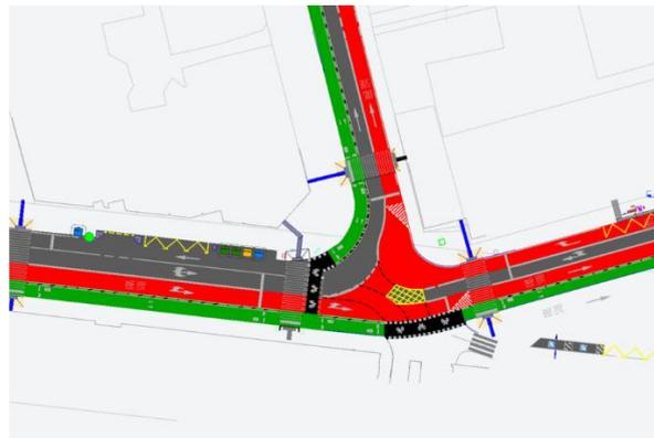
Figura 52. Detalle de la solución en la entrada del parking de la Estación Murcia el Carmen (lote 5).
