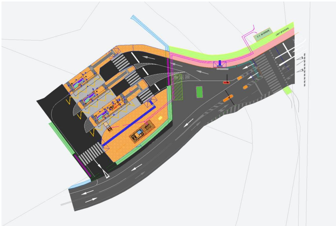
Figura 43. Cabecera de la línea 1 de autobuses que incluye un punto de recarga de autobuses eléctricos – junto a Campus de Ciencias de la Salud (lote 1).
