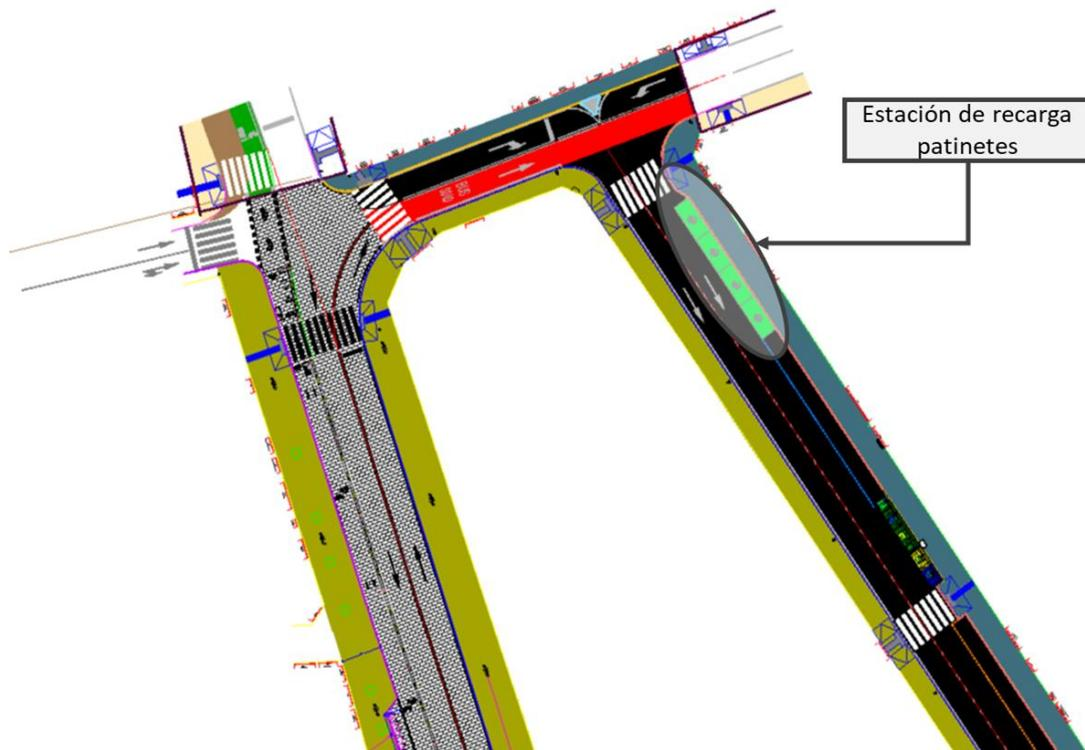
Figura 35. Nodo Floridablanca. Módulos de carga de vehículos eléctricos (2 módulos, 4 tomas).
